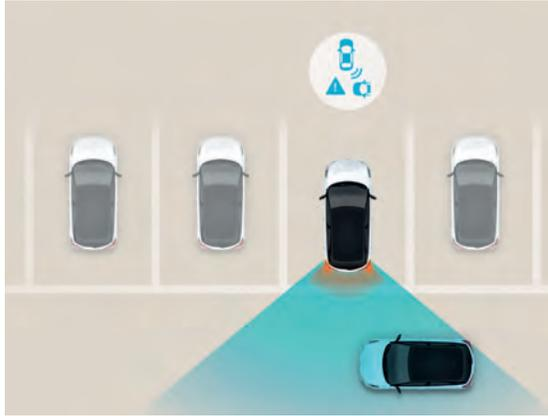
**Alerte de circulation transversale arrière avec fonction freinage.**
