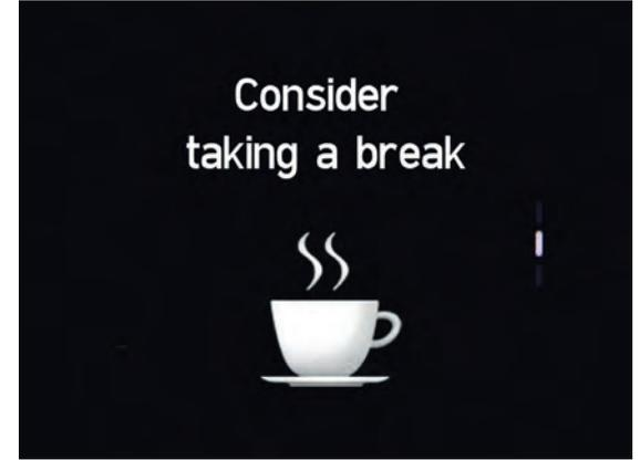
**Détection de fatigue du conducteur.**
