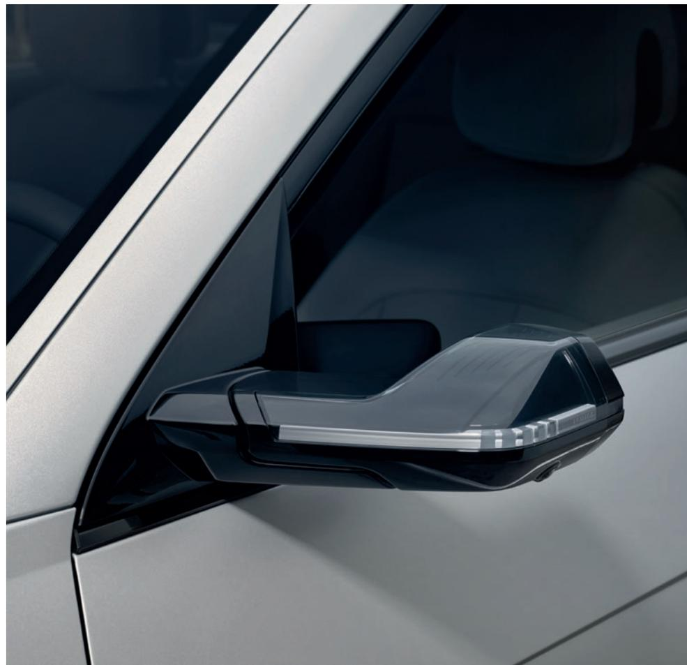
Rétroviseurs extérieurs caméra avec écrans intégrés
