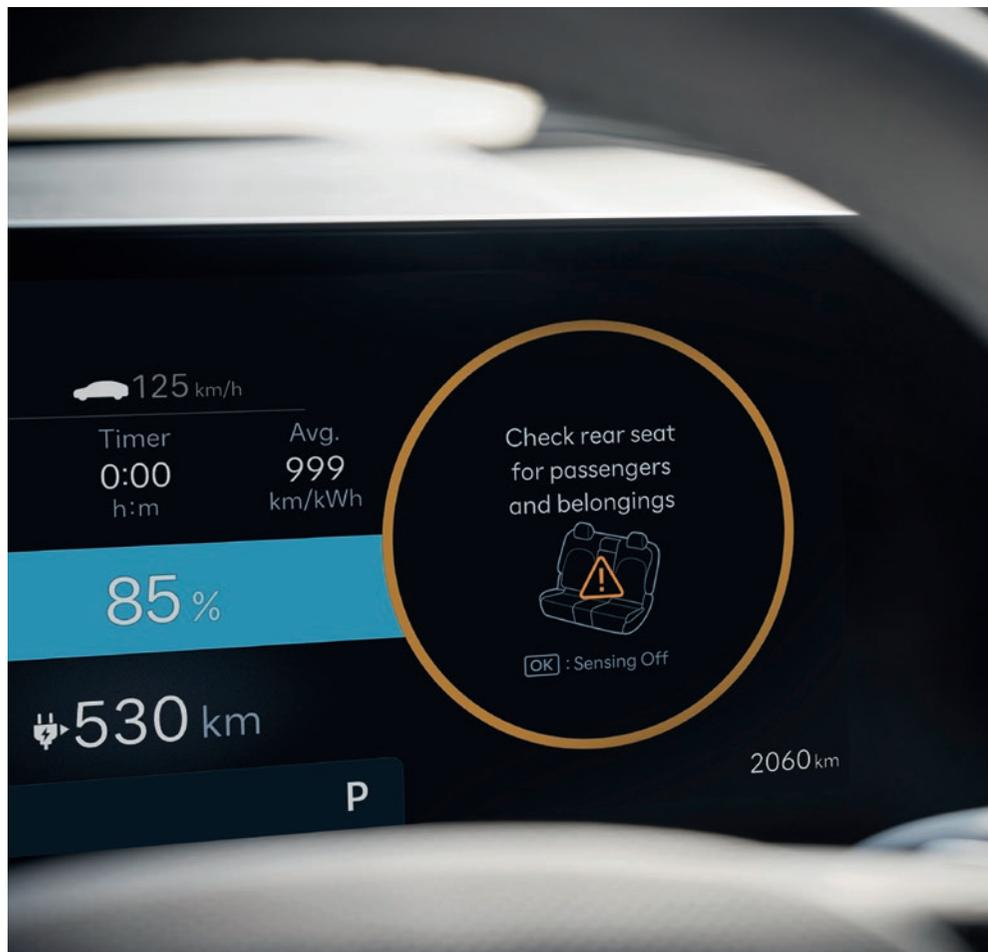
Alerte de présence de passager arrière avec système de radar
