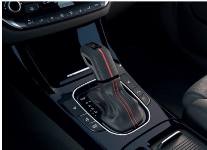
Boîte automatique DCT avec palettes au volant
