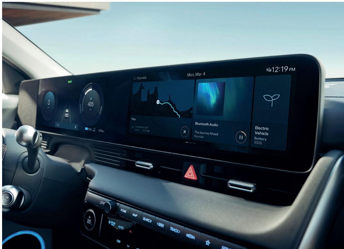
Cockpit digital avec compteurs numériques 12,3" et système multimédia doté d'un écran couleur tactile 12,3"
