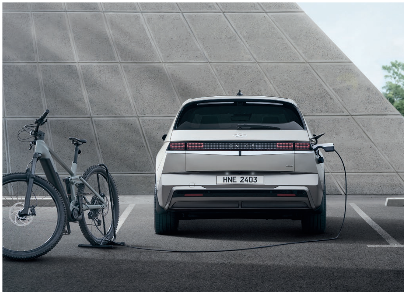
Chargeur inversé (V2L) avec adaptateur pour prise de charge extérieure
